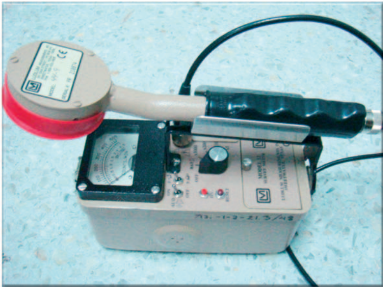
รูปที่ 21 Survey meter สำหรับตรวจวัดการเปราะเปื้อนทางรังสี
