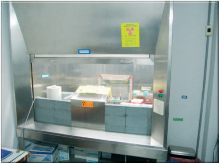
รูปที่ 7 แสดงตู้ควันทันที่ใช้ปฏิบัติงานทางรังสี
