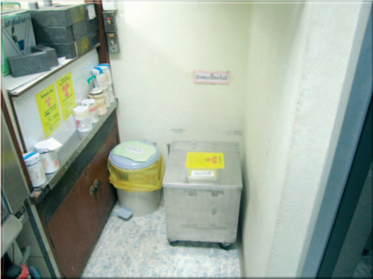
รูปที่ 3 แสดงการกำบังรังสีบริเวณที่เก็บกากกัมมันตรังสี
