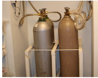
รูปที่ 2.1 ตัวอย่างการวางถังแก๊สที่เหมาะสมในห้องปฏิบัติการ (ที่มา เข้าถึงได้จาก http://blink.ucsd.edu/safety/research-lab/chemical/gas/storage.html#Basic-storage-guidelines-for-al สืบค้นเมื่อวันที่ 2 สิงหาคม 2556)
