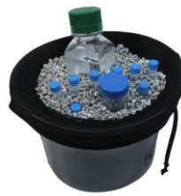
รูปที่ 2.8 ตัวอย่างตัวดูดซับสารเคมีและวัสดุกันกระแทก ที่ใช้ในการกั้นระหว่างขูดสารเคมีขณะเคลื่อนย้าย
