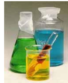
รูปที่ 2.4 การใช้แผ่นพาราฟิล์มปิดฝาภาชนะ
